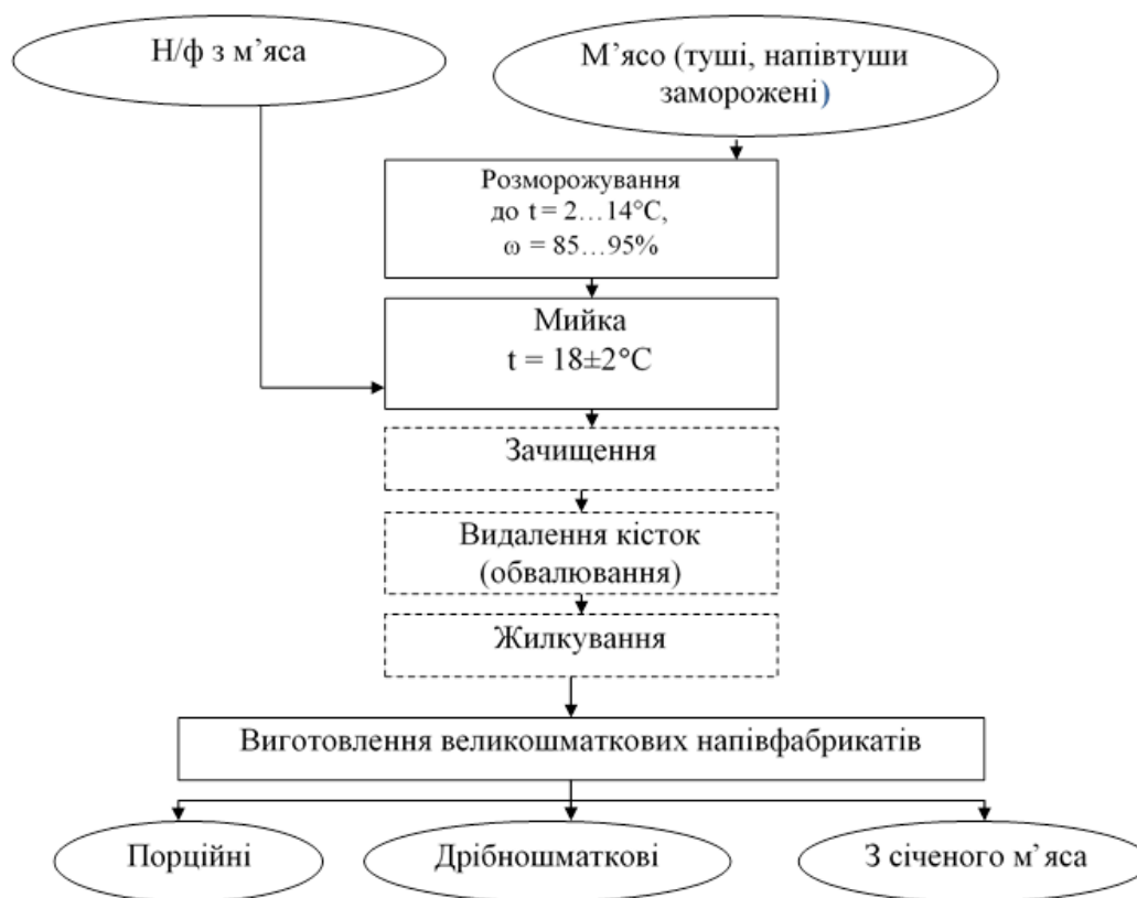
Рисунок 3.2 – Технологічна схема виробництва великошматкових напівфабрикатів з м'яса
