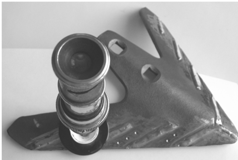
Рис. 2. Робочий процес визначення діаметру лунок
