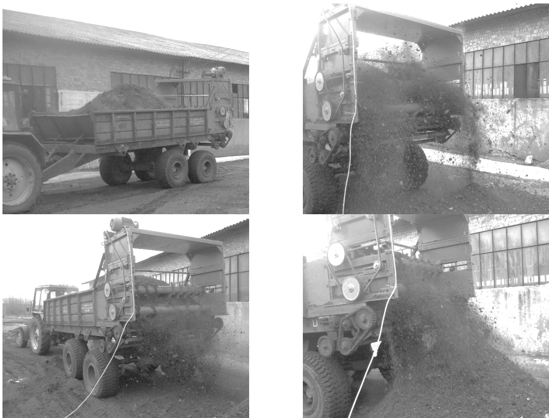
Рис. 3 – Процес механічної аерації і змішування гноє-компостної суміші на експериментальній установці на базі причіпного розкидача добрив ПРТ-10 із двобарабанним навісним пристроєм
