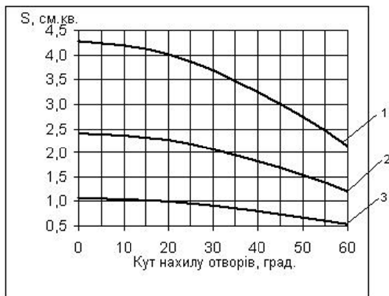
Рис. 3 – Залежність площі проекції еліпсних отворів від їх кута нахилу \beta з наступними розмірами їх полувісів a і b :
