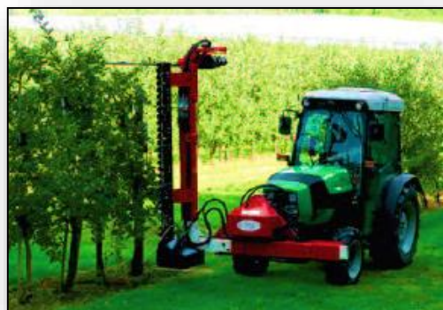
Рис. 27 Робота контурного обрізчика в саду
