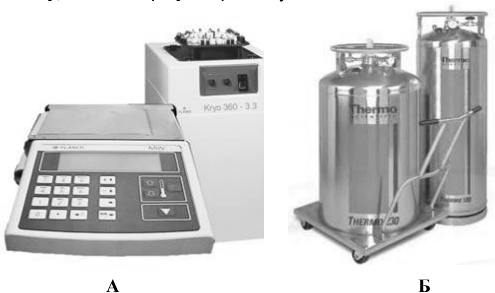
Рис. 3. Загальний вид програмного кріозаморожувача (А) та резервуара для рідкого азоту (Б). (Пояснення у тексті)
