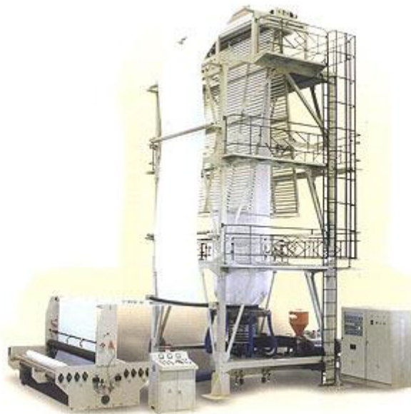
Рисунок 3.2 – Установа для виробництва плівки рукавним методом із прийманням рукава вгору
