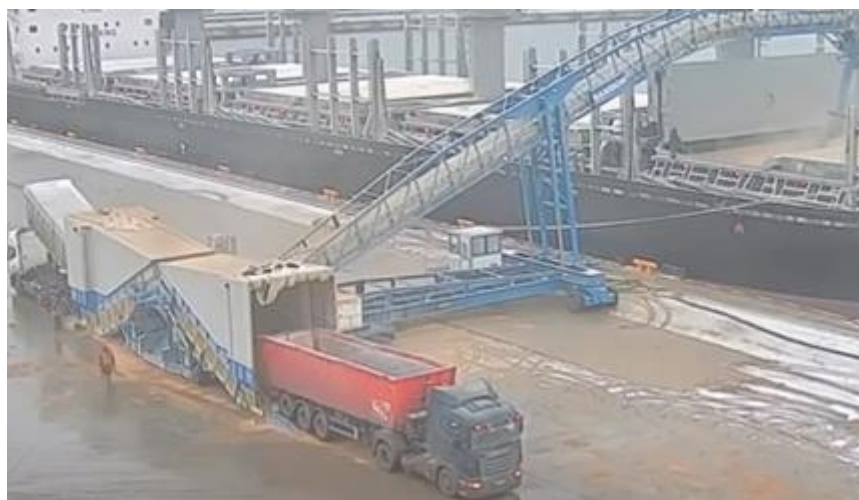
Рисунок 3 - Перевантаження зернових вантажів з автотранспорту на судно за допомогою мобільного перевантажувача
