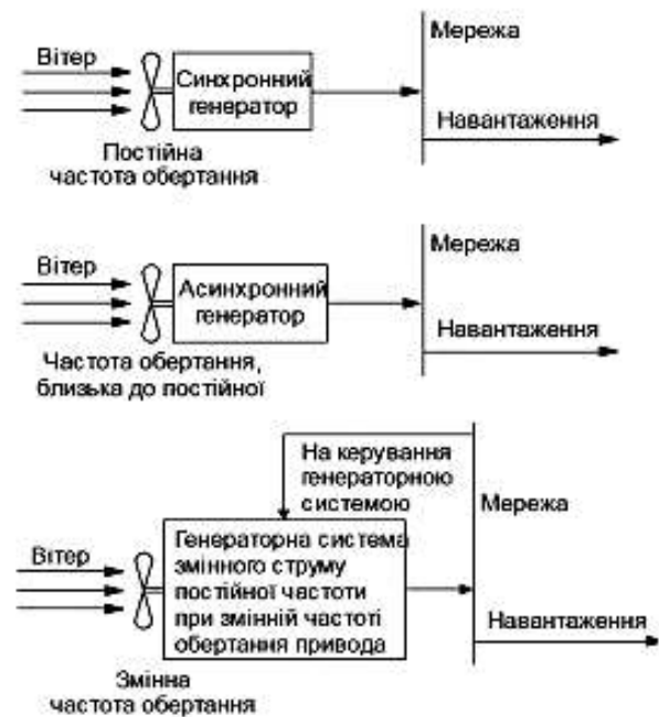
Рисунок 3 – Структурні схеми систем генерування і використання електроенергії при підключенні ВЕУ до мережі
