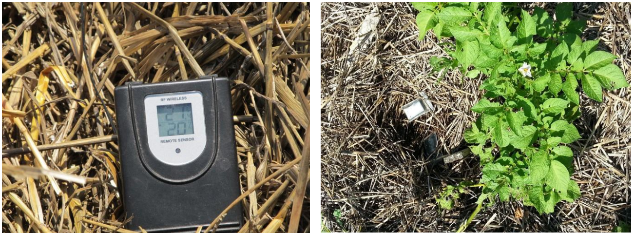
Рисунок 7 – Розміщення автономних електронних датчиків температури на дослідних ділянках
