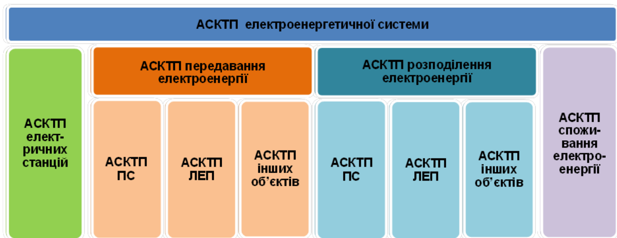
Рисунок 2.7 - Структура системи автоматизації електроенергетичної системи з виділеними АСКТП ЛЕП
