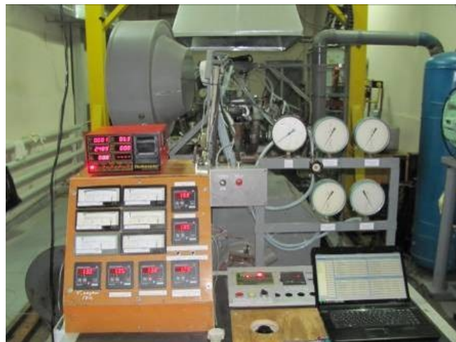
Рисунок 3.3 – Загальний вигляд комп'ютерно-діагностичного комплексу АСДД для дослідження газового ДВЗ 6 ЧГ 13/14
