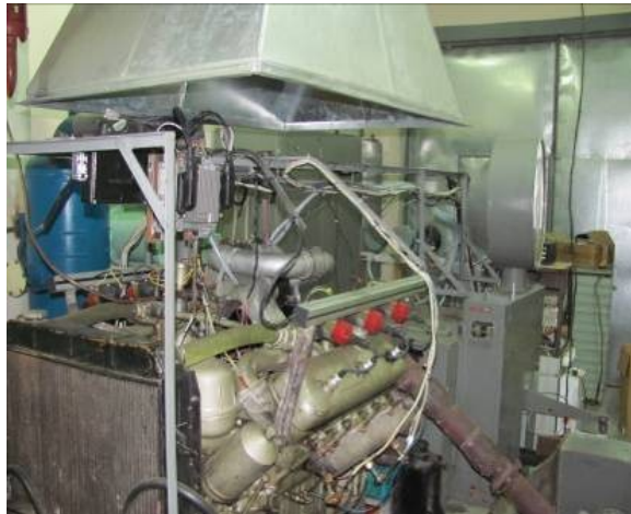
Рисунок 3.2 – Загальний вигляд пульта управління і експериментального стенду для випробувань газових ДВЗ з ГТН і комплексом АСДД
