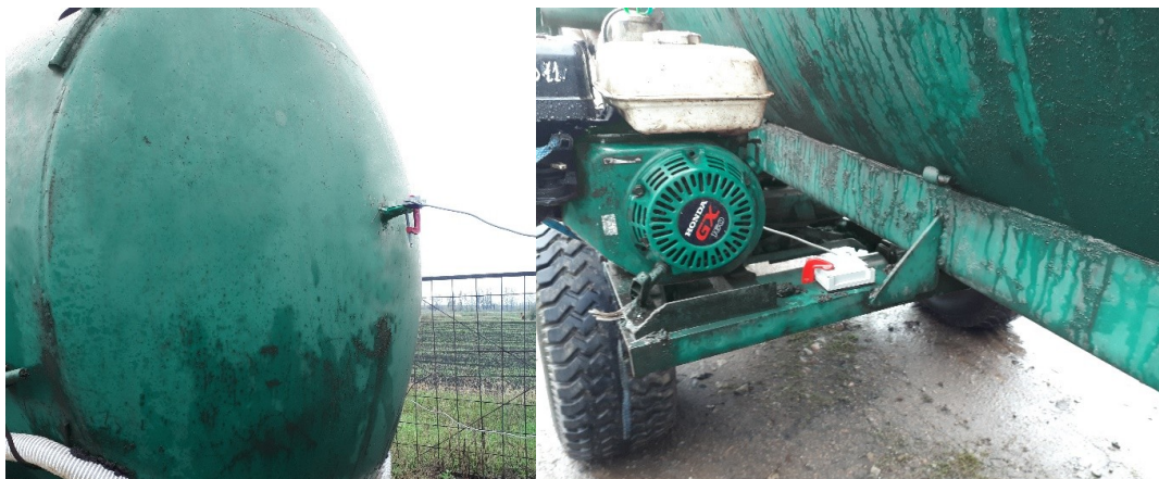
Рисунок 3.6 – Встановлення двох акселерометрів на транспортно-технологічній машині МЖТ-10
