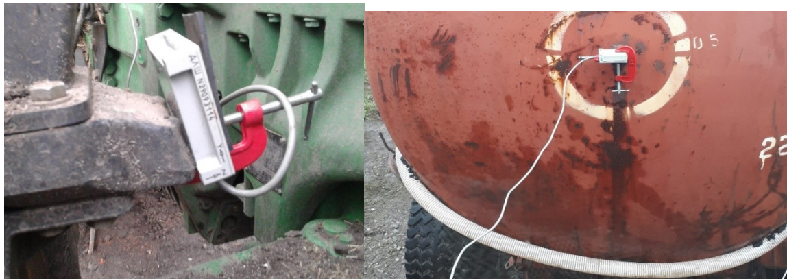
Рисунок 3.11 – Встановлення датчика прискорень на тракторі (а) і на транспортно-технологічній машині (б)
