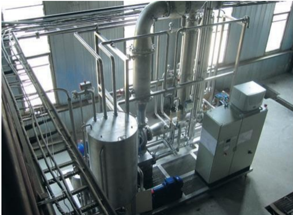
Рисунок 1.2 – Установка для фільтрації соку продуктивністю 5000 л/г
