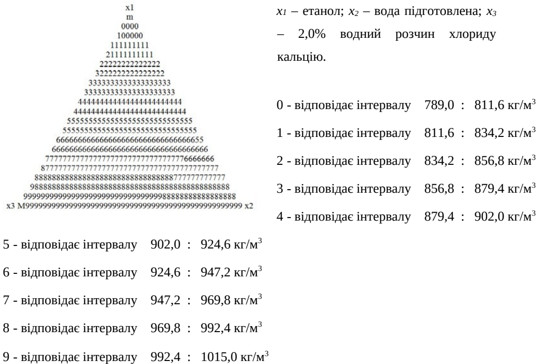
Рис. 3.21. Діаграма залежності щільності y ( x_1, x_2, x_3 ) водно 2+ від співвідношення рецептурних компонентів спиртового розчину \text{Ca}
