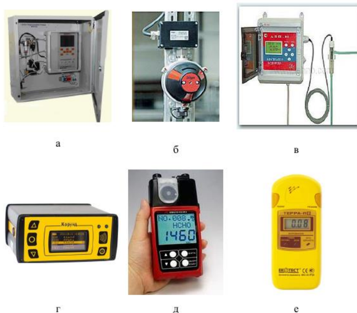
Рис. 2.6 – Прилади для радіаційного й хімічного спостереження: а – газосигналізатор газів, що відходять, стаціонарний «Дозор-С»; б – вибухозахищений інфрачервоний датчик для безперервного контролю вибухонебезпечних газів і парів «Draeger Polytron IR»; в – газоаналізатор водню стаціонарний «АВП-01Г»; г – переносний газоаналізатор на основі інтелектуальних сенсорних модулів «Корунд»; д – переносний одноканальний газоаналізатор для вимірювання формальдегіду «FP-31»; е – дозиметр-радіометр побутовий «МКС-05 ТЕРРА-ІІ плюс».
