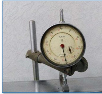
Рис.9. Навантажуємо балку силою F_2=10 Н. Фіксуємо переміщення в точці 1 ( \Delta_{12} = 0,39 мм). Результат вимірювання заносимо в табл. 1.
