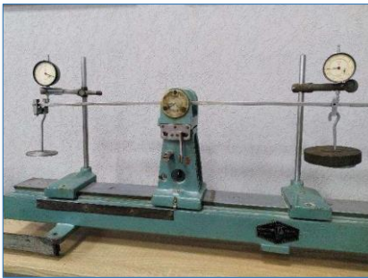
Рис.9. Навантажуємо балку силою F_1=10 Н. Фіксуємо переміщення в точці 2 ( \Delta_{21} = 0,39 мм). Результат вимірювання заносимо в табл. 1.
