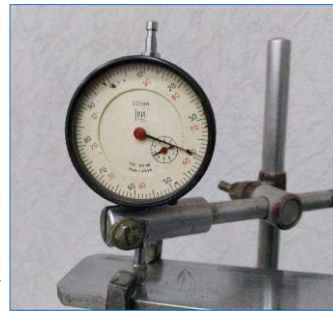
Рис.9. Навантажуємо балку силою F_1=10 Н. Фіксуємо переміщення в точці 2 ( \Delta_{21} = 0,39 мм). Результат вимірювання заносимо в табл. 1.
