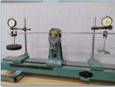
Рис.9. Навантажуємо балку силою F_2=10 Н. Фіксуємо переміщення в точці 1 ( \Delta_{12} = 0,39 мм). Результат вимірювання заносимо в табл. 1.
