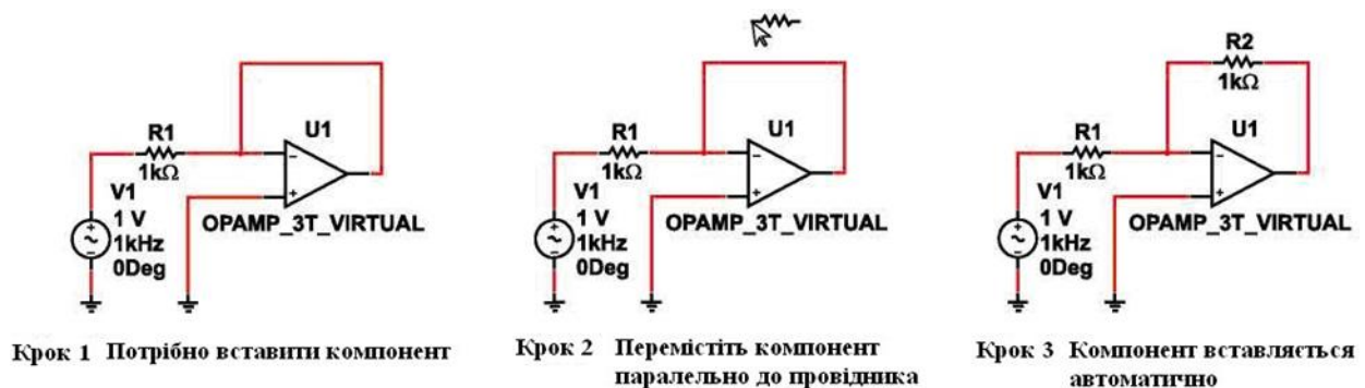
Рисунок 13 – Автоматичне розміщення компонентів
