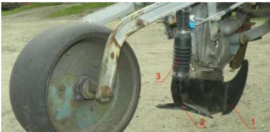
Рис. 1. Посівна секція для внутрішньогрунтового післяпосівного внесення попередньо спіненого гербіциду: 1 – полозовидний сошник; 2 – стрільчастий подовжувач сошника; 3 – піногенератор
