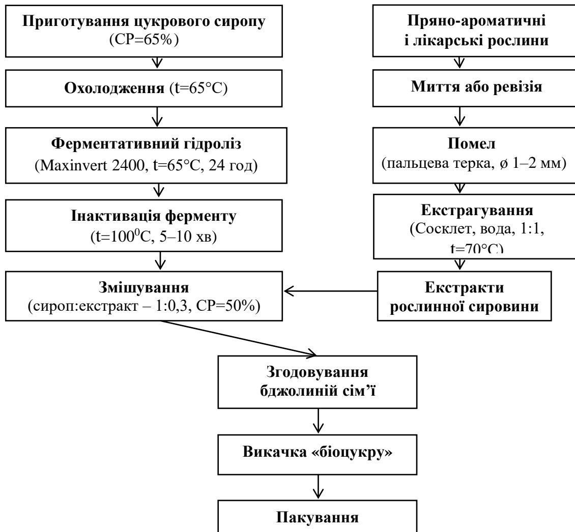
Рис. 7. Принципова технологічна схема одержання «біоцукру»
