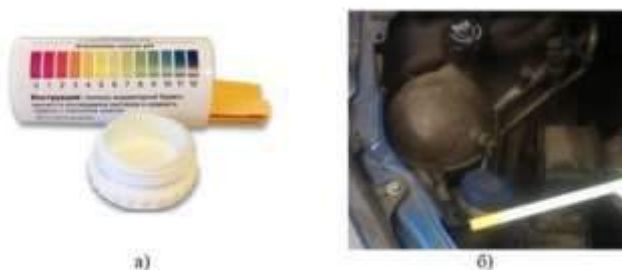
Рис. 1 – Перевірка рН антифризу: а) тест-смужки; б) перевірка за допомогою тест-смужок
