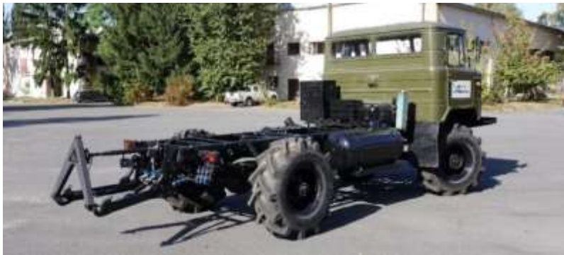
Рис. 1. Мобільний енергетичний засіб МЕЗ-115 «Автотрактор»
