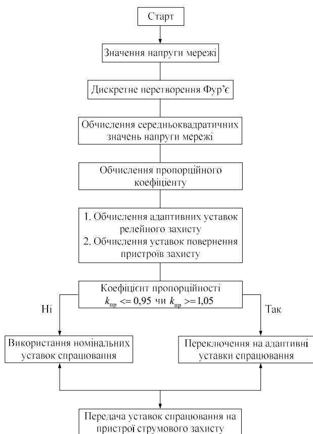
Рисунок 5 – Алгоритм роботи системи адаптації уставок спрацьовування струмових захистів
