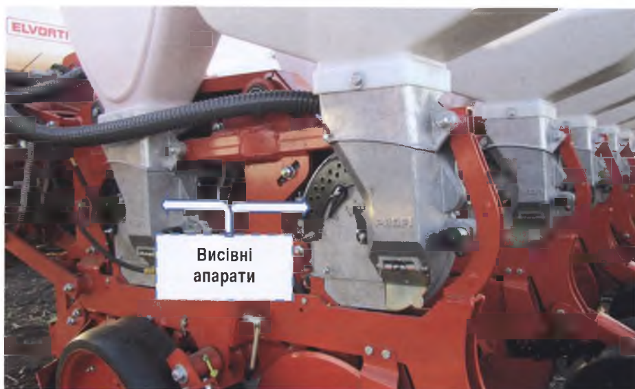
Здвоєні висівні апарати сівалки Vega 8 Profi
