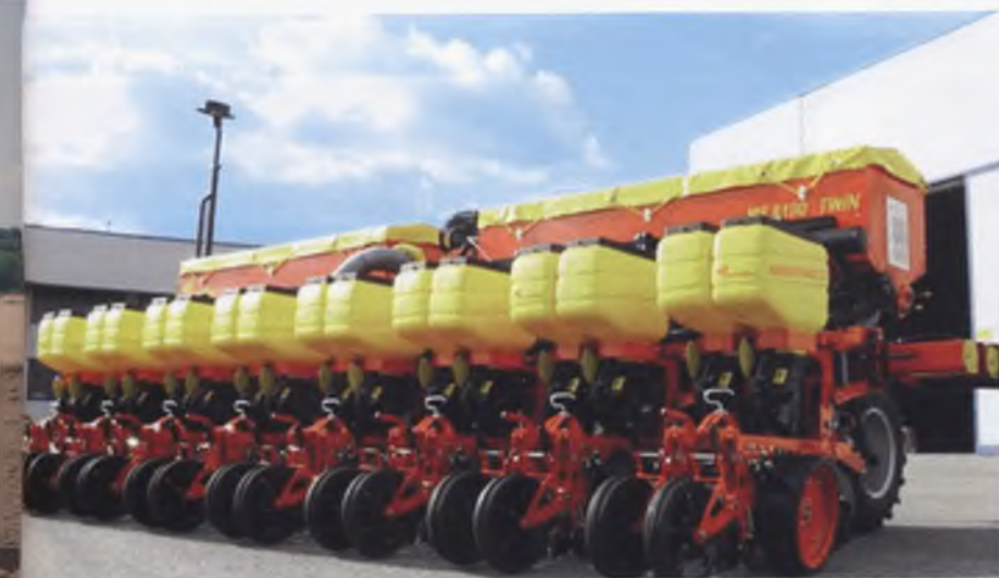
Сівалка точного висіву в два рядки виробництва італійської компанії MaterMass MS TWIN ROW 8100
