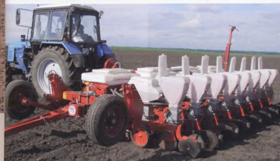
Сівалка точного висіву дворядкового посіву сумісних культур виробництва української компанії ПАТ «Ельворті» «Vega 8 Profi»
