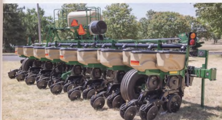
Причіпна 8-рядна сівалка для просапних культур Yield-Pro® YP-825A з можливістю сівби в здвоєний рядок
