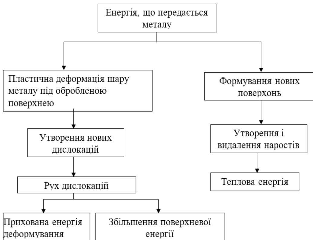
Рисунок 3.18 - Схема дислокаційно-енергетичної моделі розподілу енергії, що передається металу в процесі обробки металевою щіткою.
