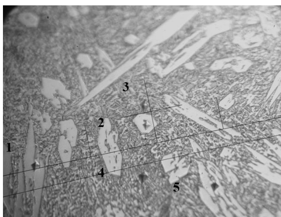
Рисунок. 3.10 – Зони вимірювання мікротвердості поверхні наплавлення електродом з обмазкою глиною
