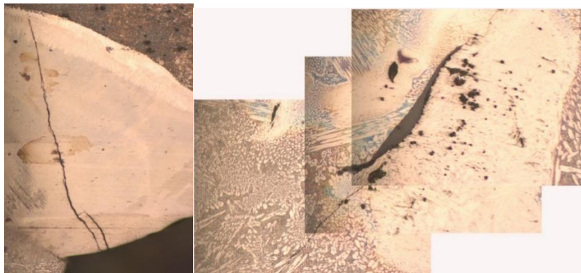
Рисунок. 3.17– Тріщини на поверхні при наплавленні електродом
