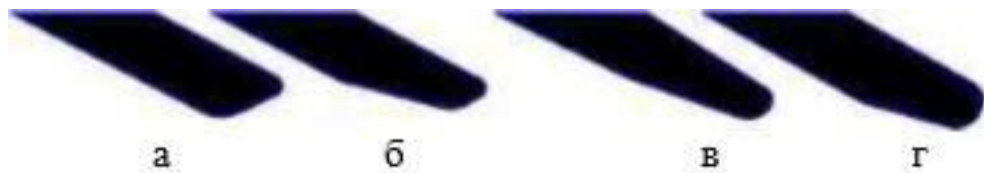
Рис. 1.10 - Характер зміни профілю різальних елементів стрілочастих лап на різних ґрунтах
