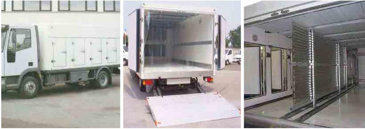
Рисунок 2.8 - Приклад монтажу евтектичних плит в рефрижераторному транспорті
