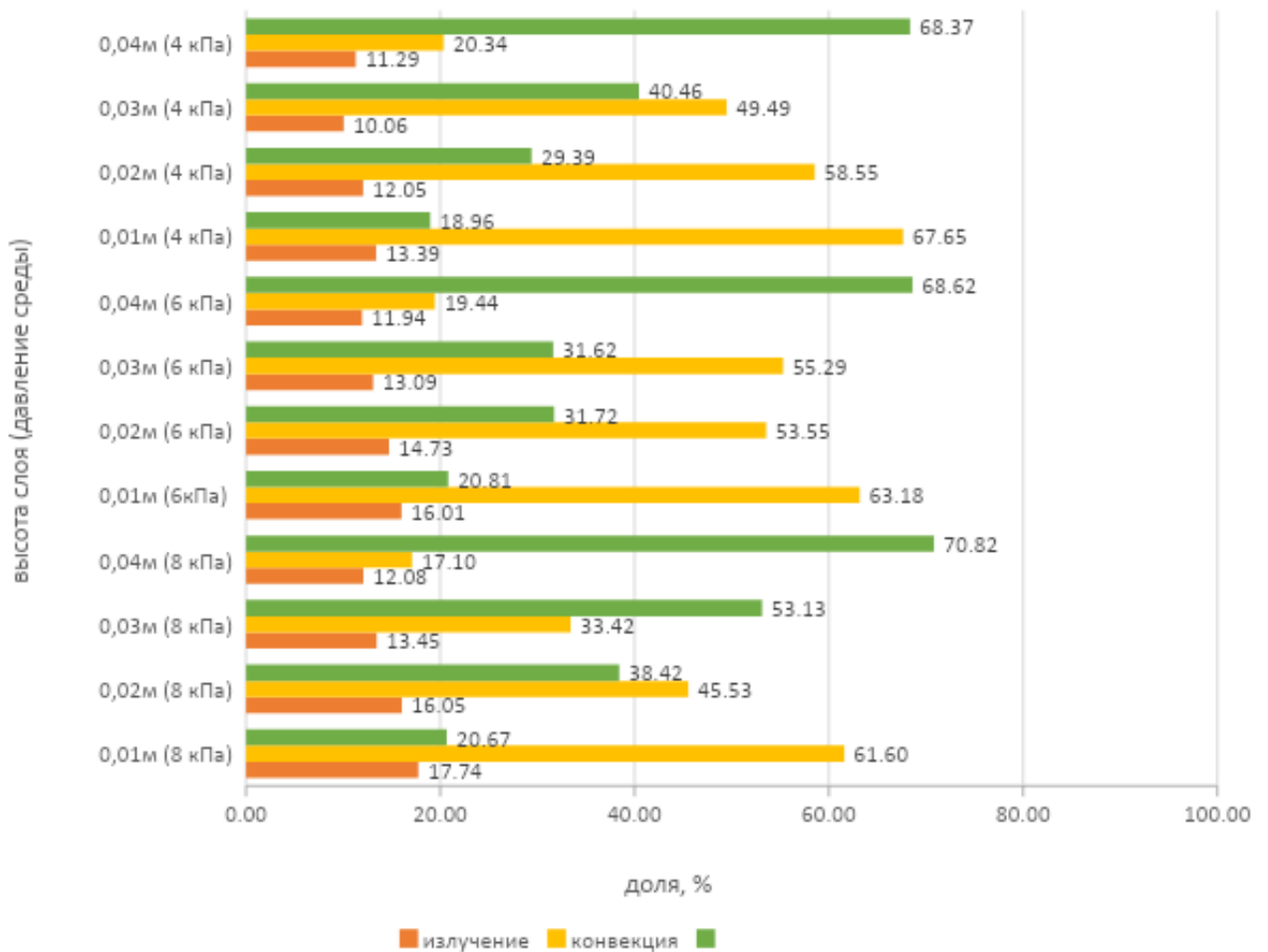
Рисунок 1.4 - Частка кожного виду теплообміну (%) при вакуумному сушінні бульб топінамбуру при температурі 55 °С.
