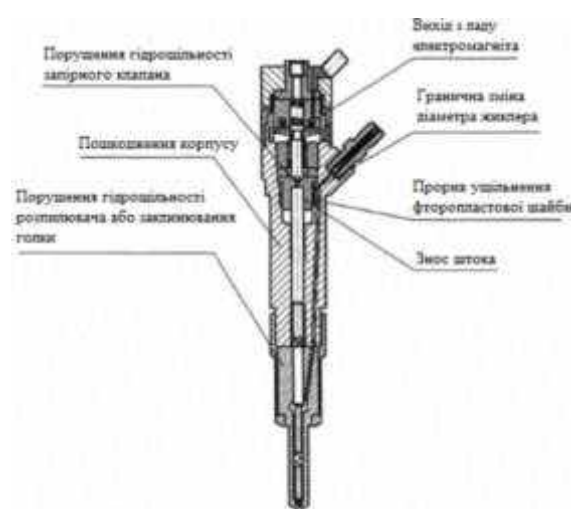
Рис. 2. Типові дефекти електрогідравлічних форсунок.
