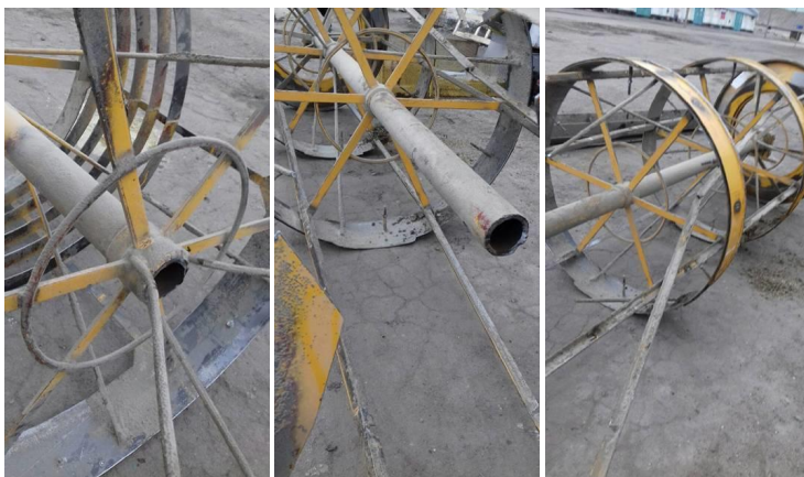
Рис. 2. Руйнування вала барабану
