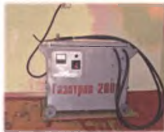
Рис. 5 – Воднево-киснева газозварювальна установка "ГАЗОТРОН - 2000" Установка "Газотрон-2000" (ТУУ 14082071-001-94) повноцінно замінює ацетилено-кисневе зварювання та використовується для ремонту сільськогосподарських машин і автомобілів. Розробники: к.т.н. проф. Сідашенко О.І., канд. техн. наук Тридуб, канд. техн. наук Шержуков І.Г.
