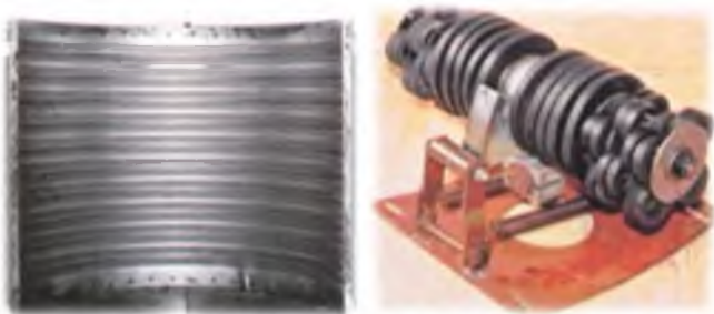
Рис. 2 – Нові конструкції циліндричних решіт, на поперечних, повздовжніх перемичках яких виштампувані рифлі або самі поперечні перемички є виштампуваними рифлями випуклістю всередину решета. Розробники: д-р техн. наук, проф. Тіщенко Л.М., д-р техн. наук, с. н. с. Гончаров Є.С., канд. техн. наук, с. н. с. Прилуцький А.Н., інж. Пуха В.М.
