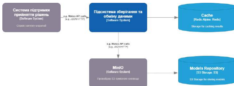
Рис. 1. Архітектурна модель мікросервісу
