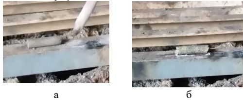
Рис.3. МКМ після: а – формування; б – СВС-процесу
