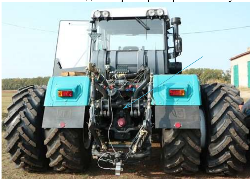
Рисунок 2.3 – Розташування баласту на рамі трактора
