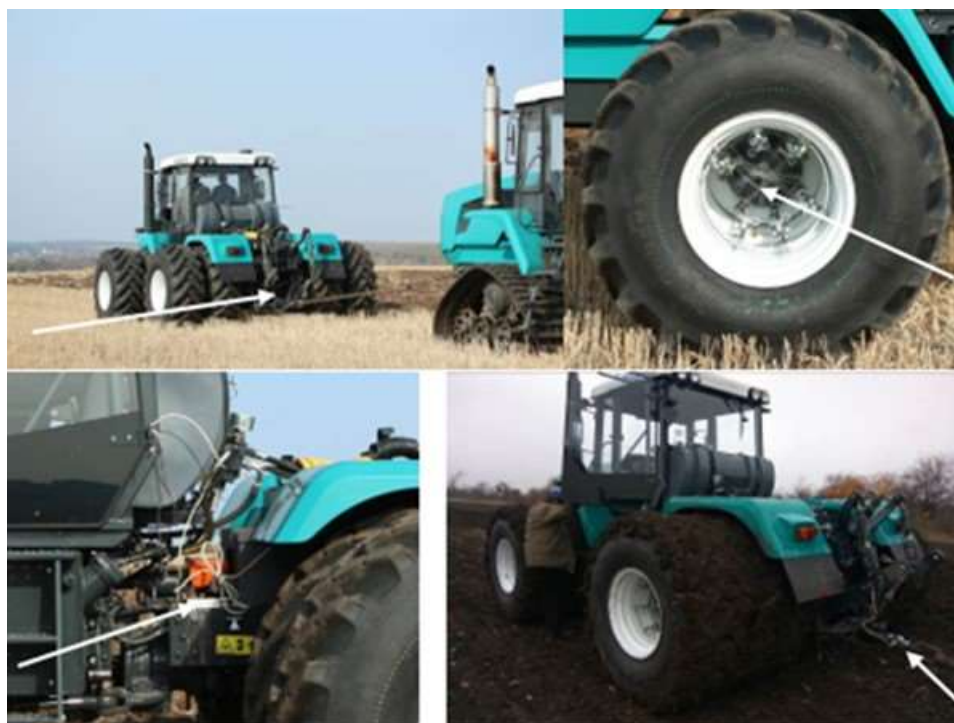
Рисунок 3.3 – Загальний вигляд датчиків та їх розташування на тракторі ХТЗ-242К.20
