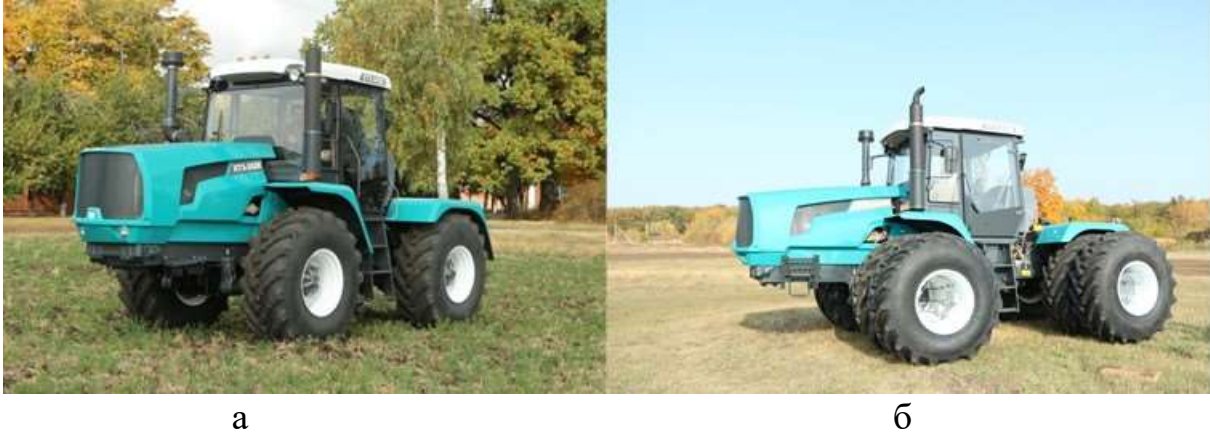
Рисунок 2.2 – Трактор ХТЗ-242К.20 на одинарних (а) та здвоєних колісних системах (б)
