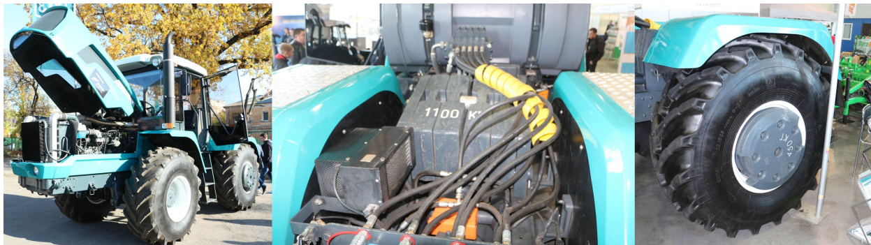
Рисунок 3.17 – Трактор ХТЗ-248К.20 з встановленим баластом на рамі та задніх колесах
