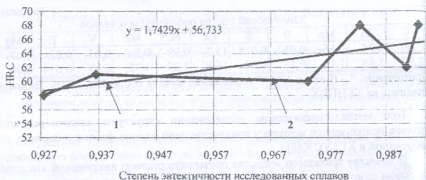
Рис. 1. Зависимость HRC от степени эвтектичности
