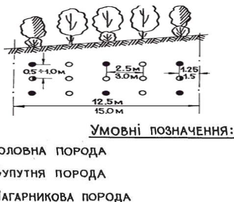
Рис. 7.1 Схема створення ажурної полезахисної смуги в умовах Північного Степу
