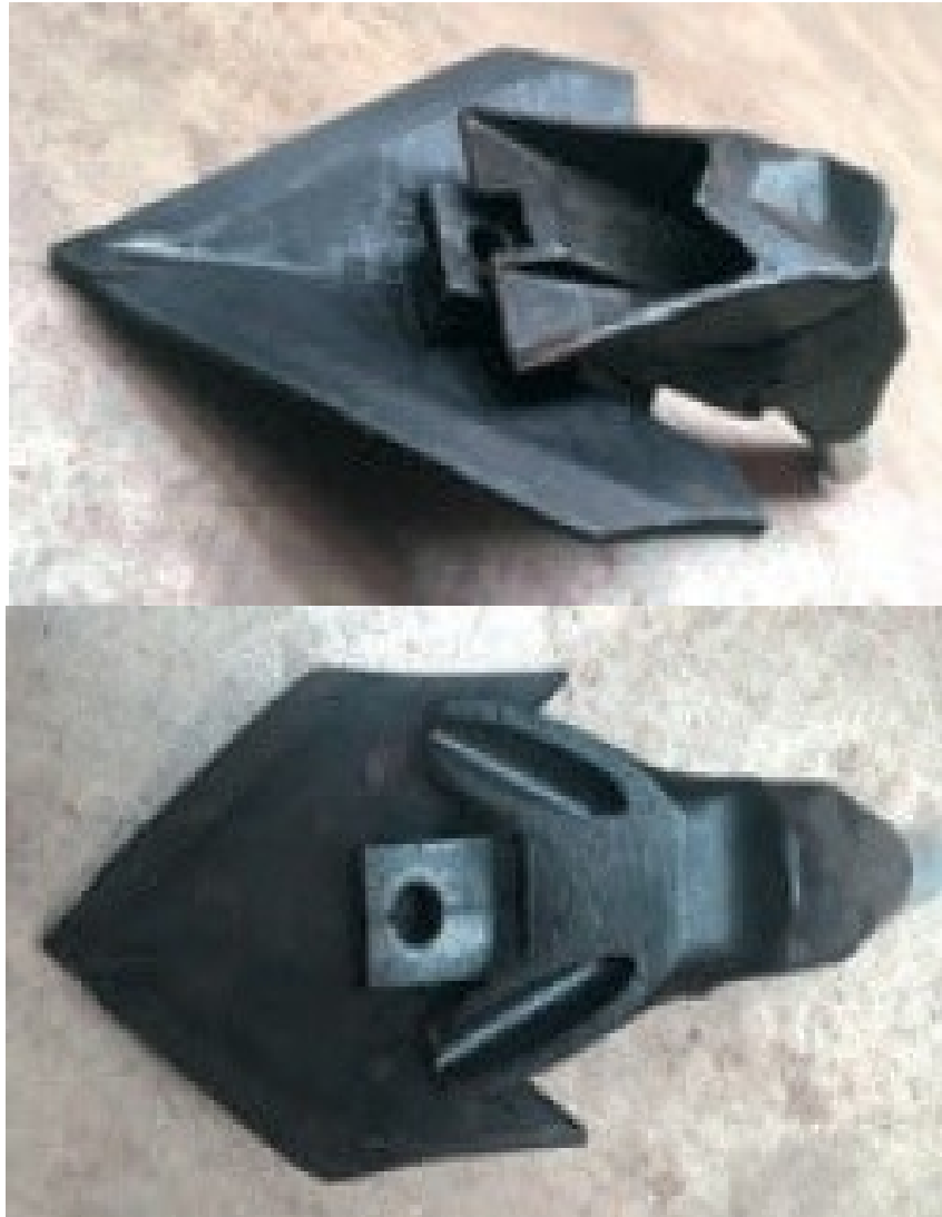
Рис. 6. Лапи агрегату Claydon Hydrid-T4 для одночасного розпушування ґрунту, сівби та внесення добрив у зону висіву насіння
