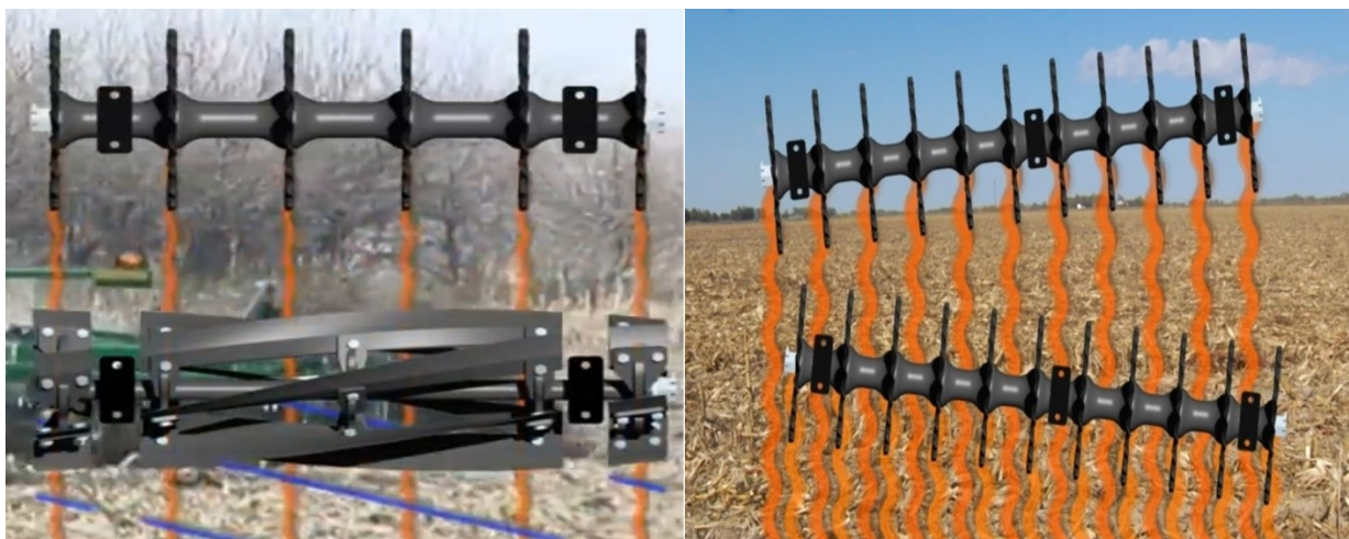
Рис. 10. Батарея турбоколтерів із встановленим за нею турбочопером (зліва) і батареї турбоколтерів зі змінним кутом атаки від 0 до 6° (принцип роботи агрегату турбомакс) (справа)
