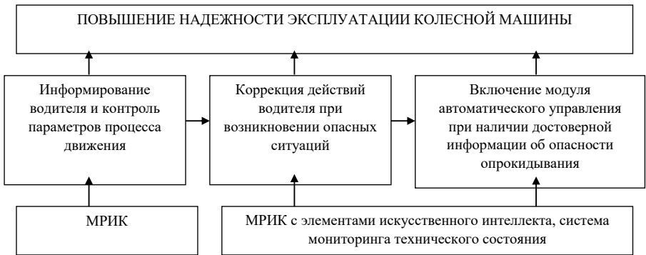
Рис.5. Структурная схема обеспечения надежности эксплуатации колесной машины
