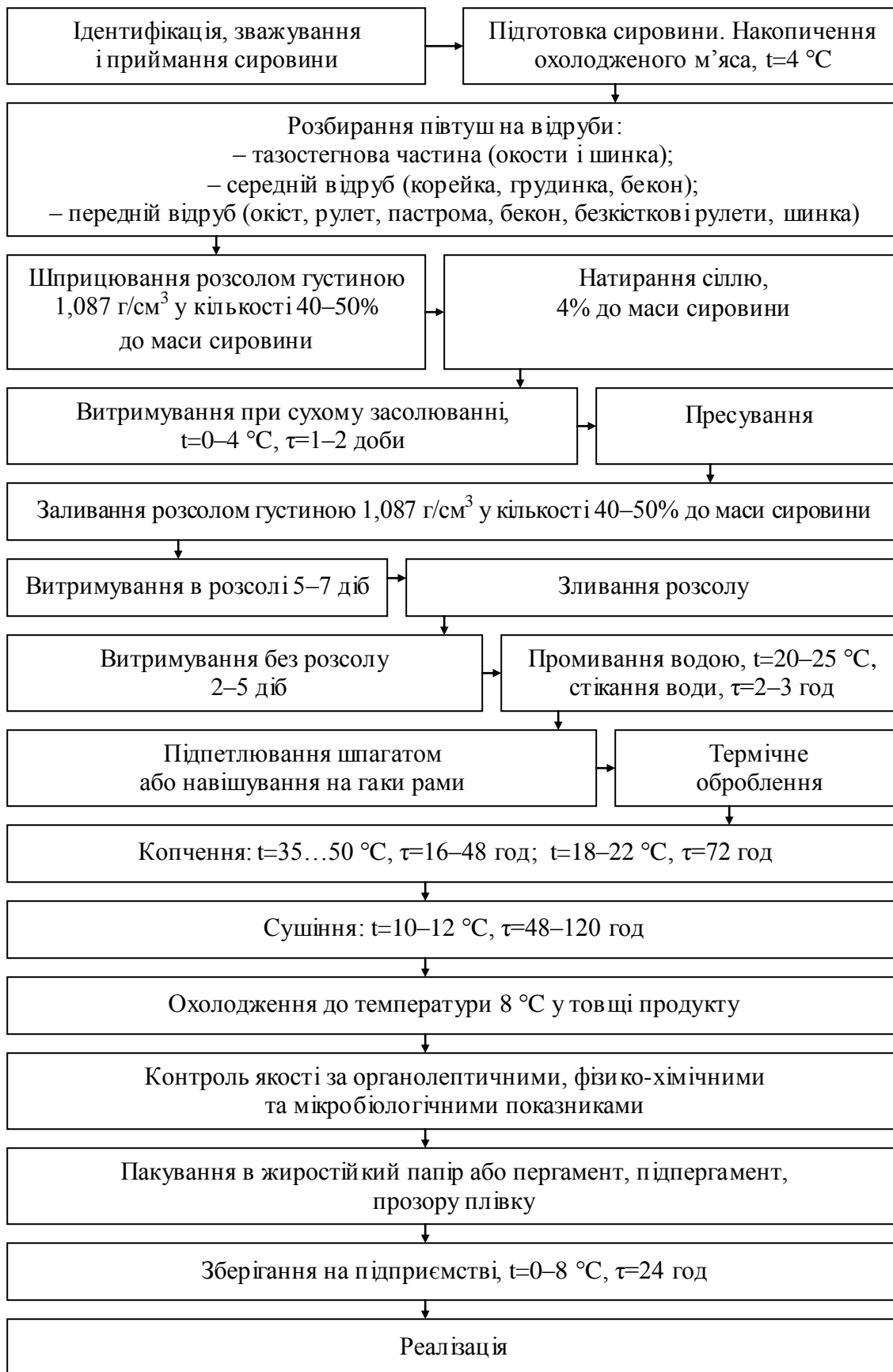
Рисунок 5.2 – Технологічна схема виробництва сирокопчених виробів зі свинини
