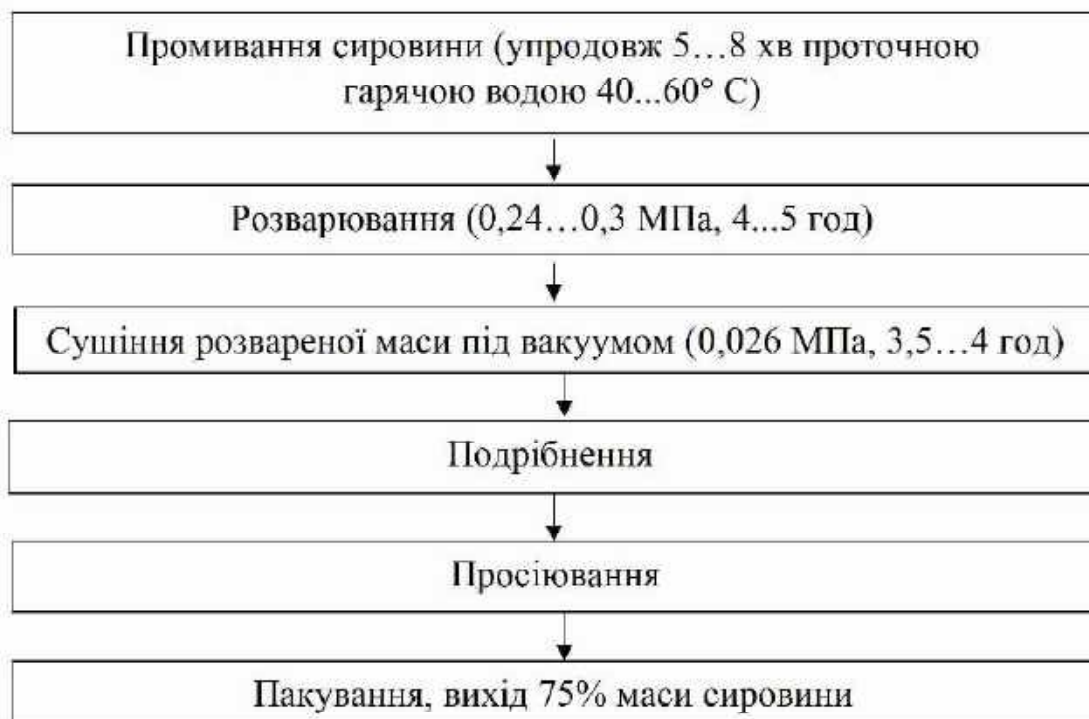
Рисунок 12.2 – Технологічний процес виробництва рого-копитного кормового борошна
