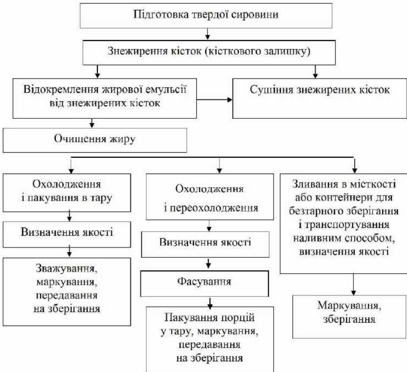
Рисунок 10.2 – Технологічна схема виробництва тваринних жирів із твердої сировини
