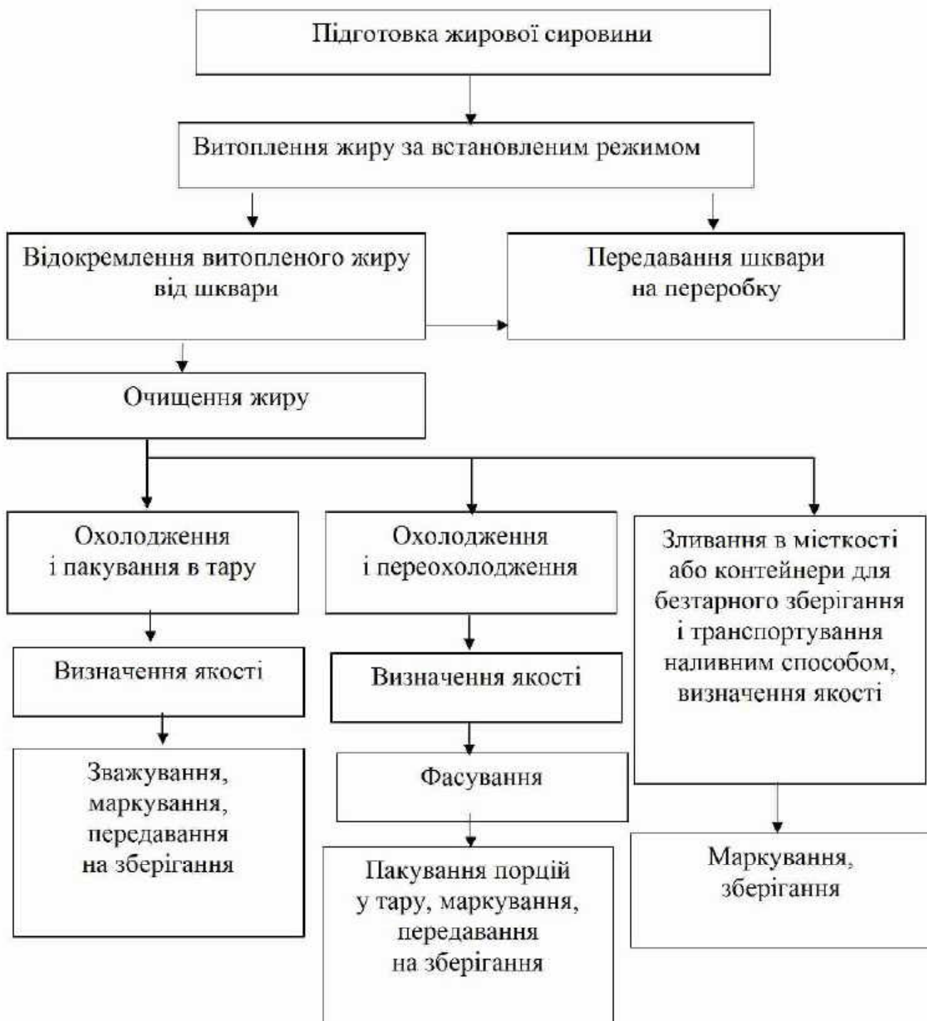
Рисунок 10.1 – Технологічна схема виробництва тваринних жирів
