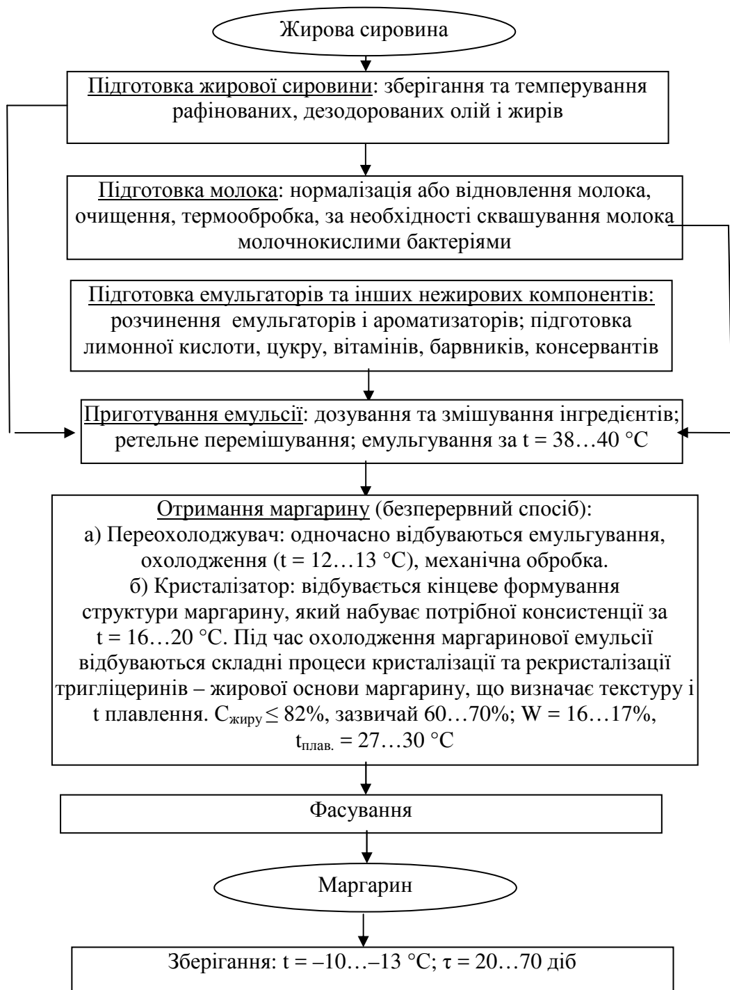
Рисунок 5.5 – Загальна технологічна схема маргарину
