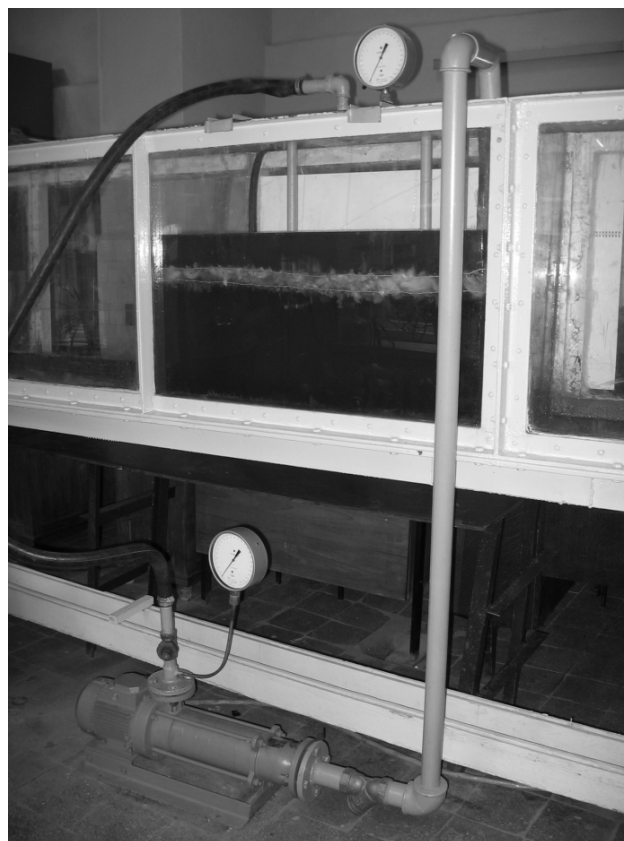
Рисунок 1 – Лабораторная установка мойки шерсти с помощью плоских гидродинамических излучателей
