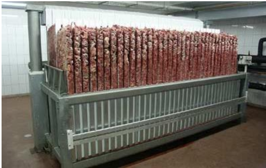
Рисунок 2.41 – Вертикально-плитковий апарат у положенні для вивантаження
