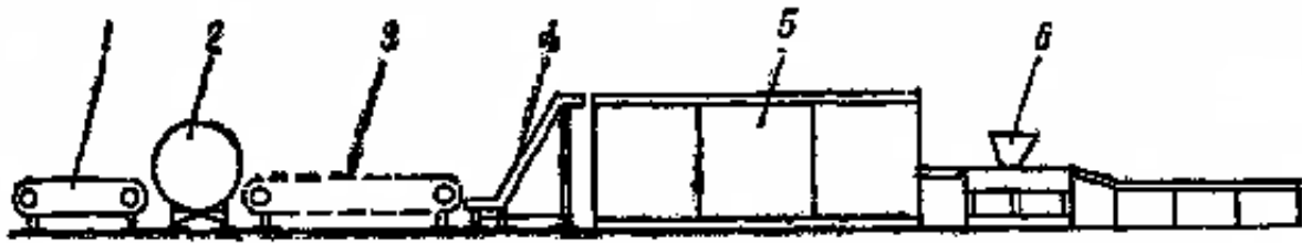
Рисунок 2.76 – Поточна лінія для виробництва морожених ягід у дрібному упакованні: 1 – стрічковий транспортер (інспекційний); 2 – мийна машина; 3 – сітчастий транспортер; 4 – елеватор; 5 – флюїдизаційний морозильний апарат; 6 – фасувальний автомат
