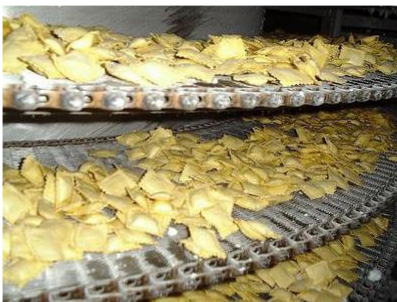
Рисунок 2.18 – Заморожування продукту в спіральному морозильному апараті
