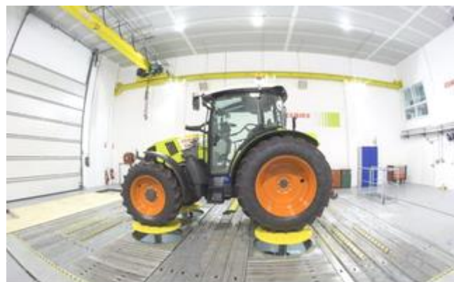
Рис. 7.10. Випробування надійності трактора щодо вібраційних параметрів
