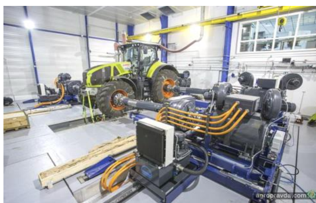
Рис. 7.12. Загальний вигляд стенду випробувань тракторів (Claas)
