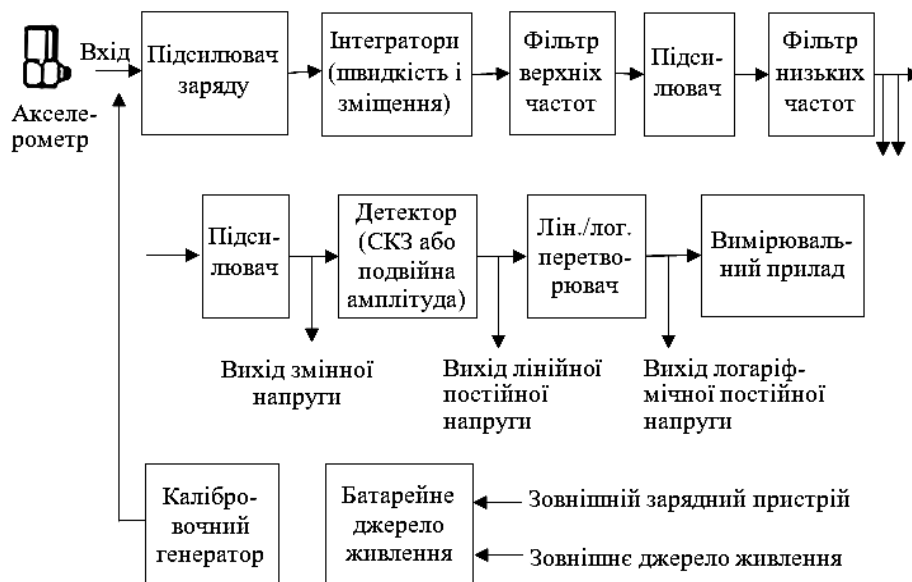
Рис. 4.16. Блок-схема конструкції й принципу дії віброметра
