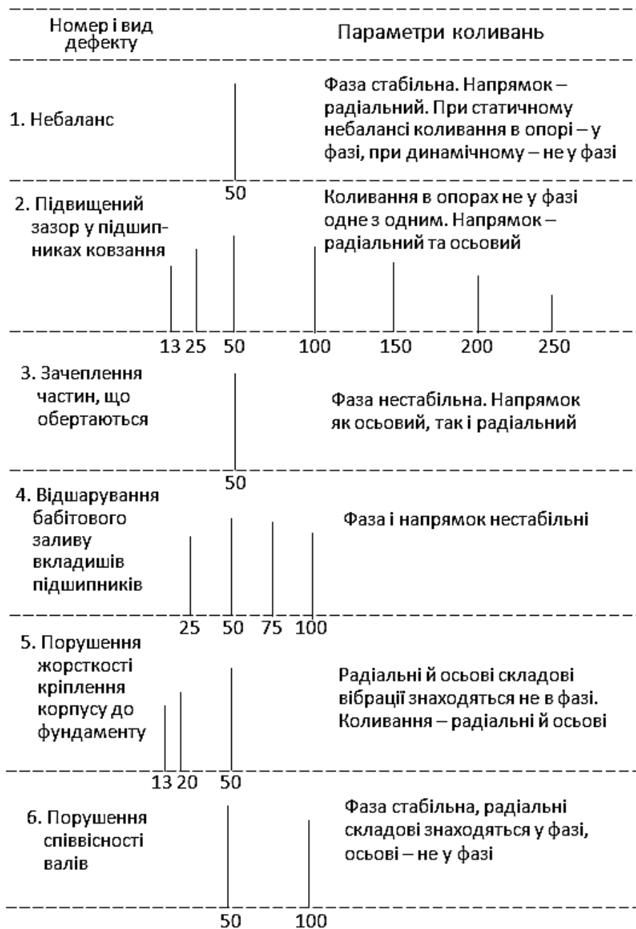
Рис. 5.17. Складові вібрації, збудованої агрегатом на підшипниках ковзання
