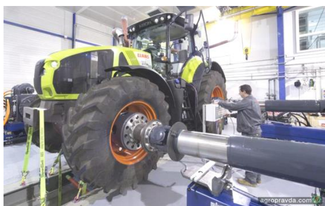
Рис. 7.11. Випробування трактора Ахіон на гальмівному стенді
