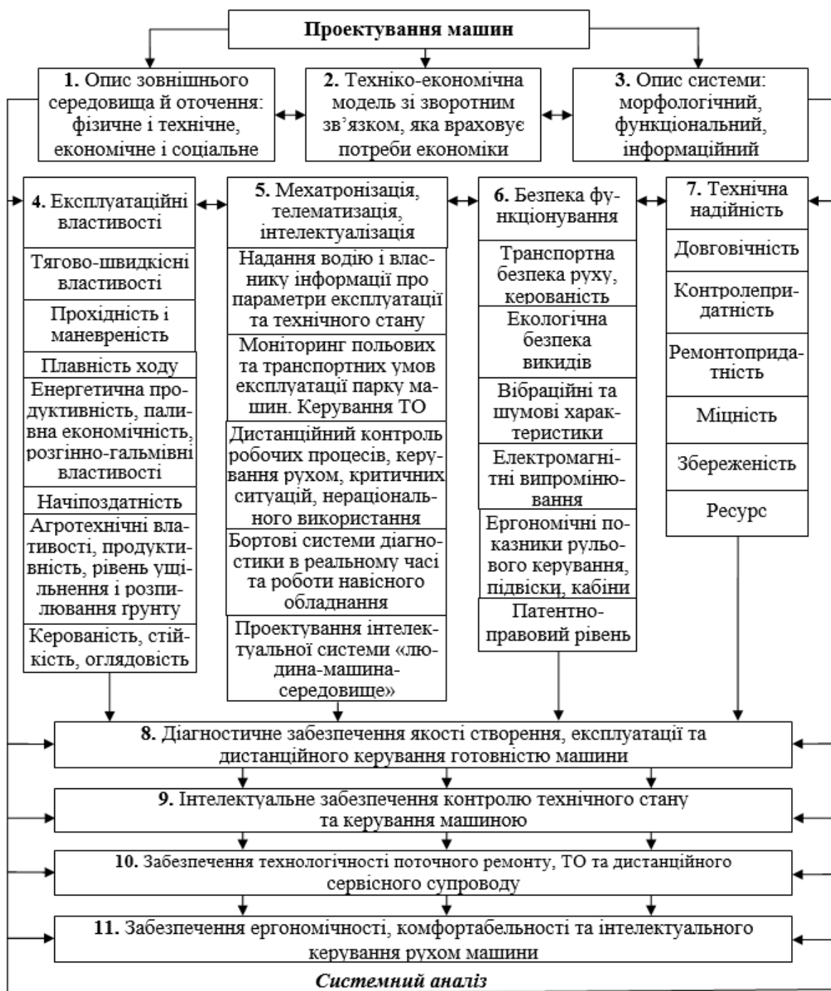
Рис. 2.4. Структурна схема основних завдань і системного підходу до їх розв'язання при проектуванні машин
