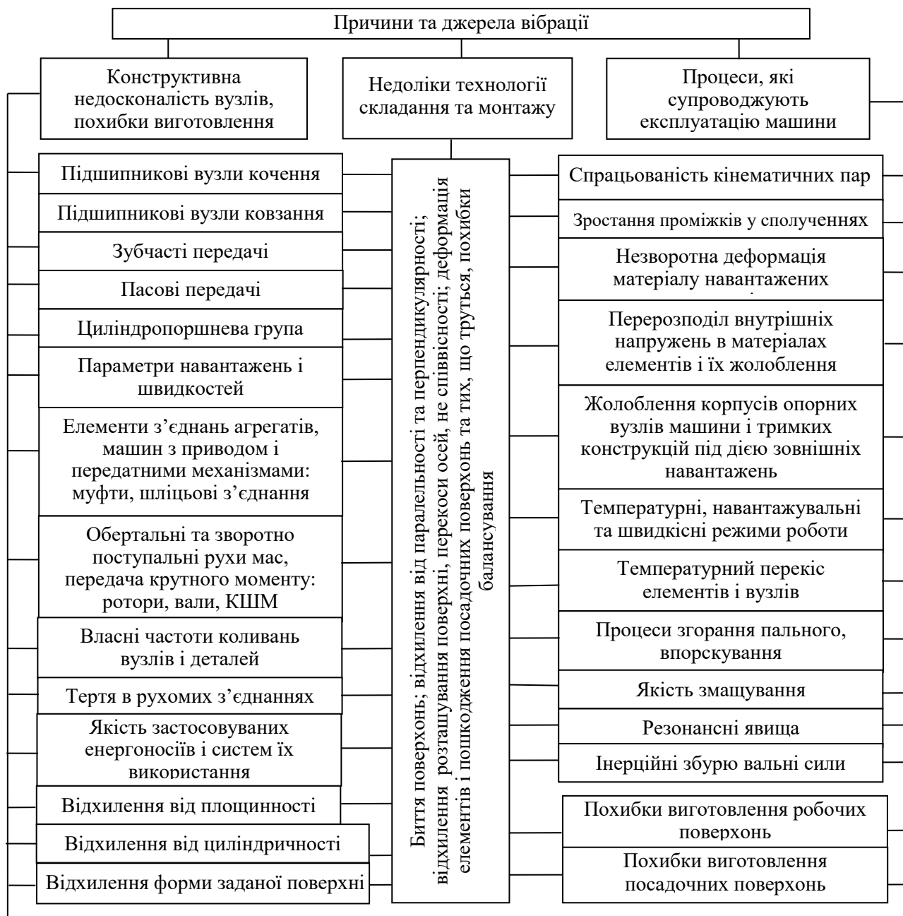
Рис. 2.13. Причини і джерела вібрації машини механічного походження
