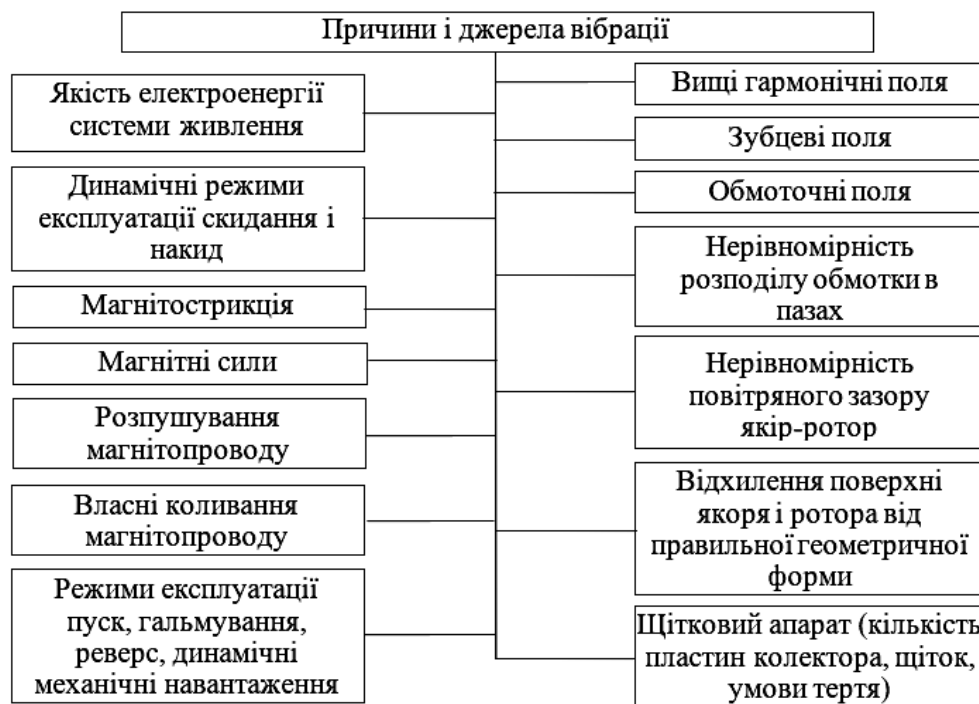
Рис. 2.25. Причини та джерела вібрації електромагнітного походження електродвигуна
