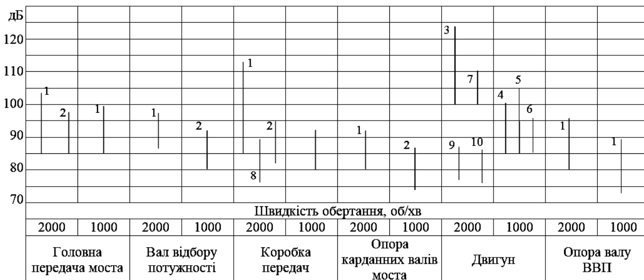
Рис. 8.4. Розкид рівнів вібрації агрегатів і механізмів трактора Т-150К, збудованої підшипниками кочення:
