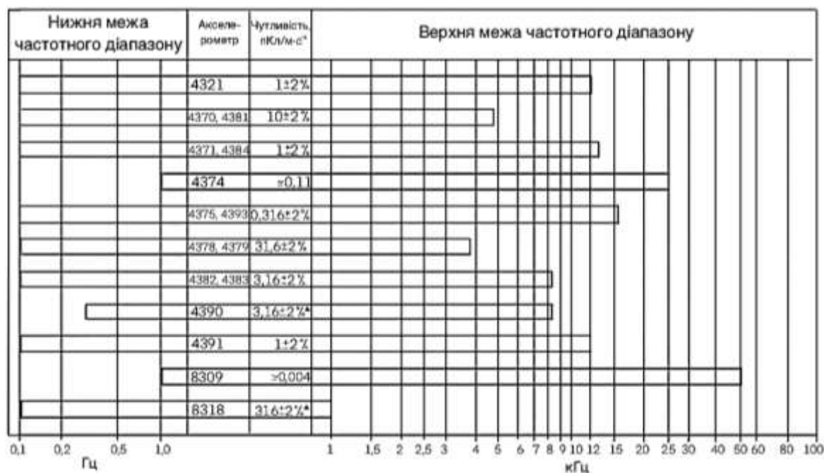
Рис. 4.5. Нижні й верхні межі робочих динамічних діапазонів і значення маси виготовлених фірмою Brüel & Kjaer акселерометрів загального призначення
