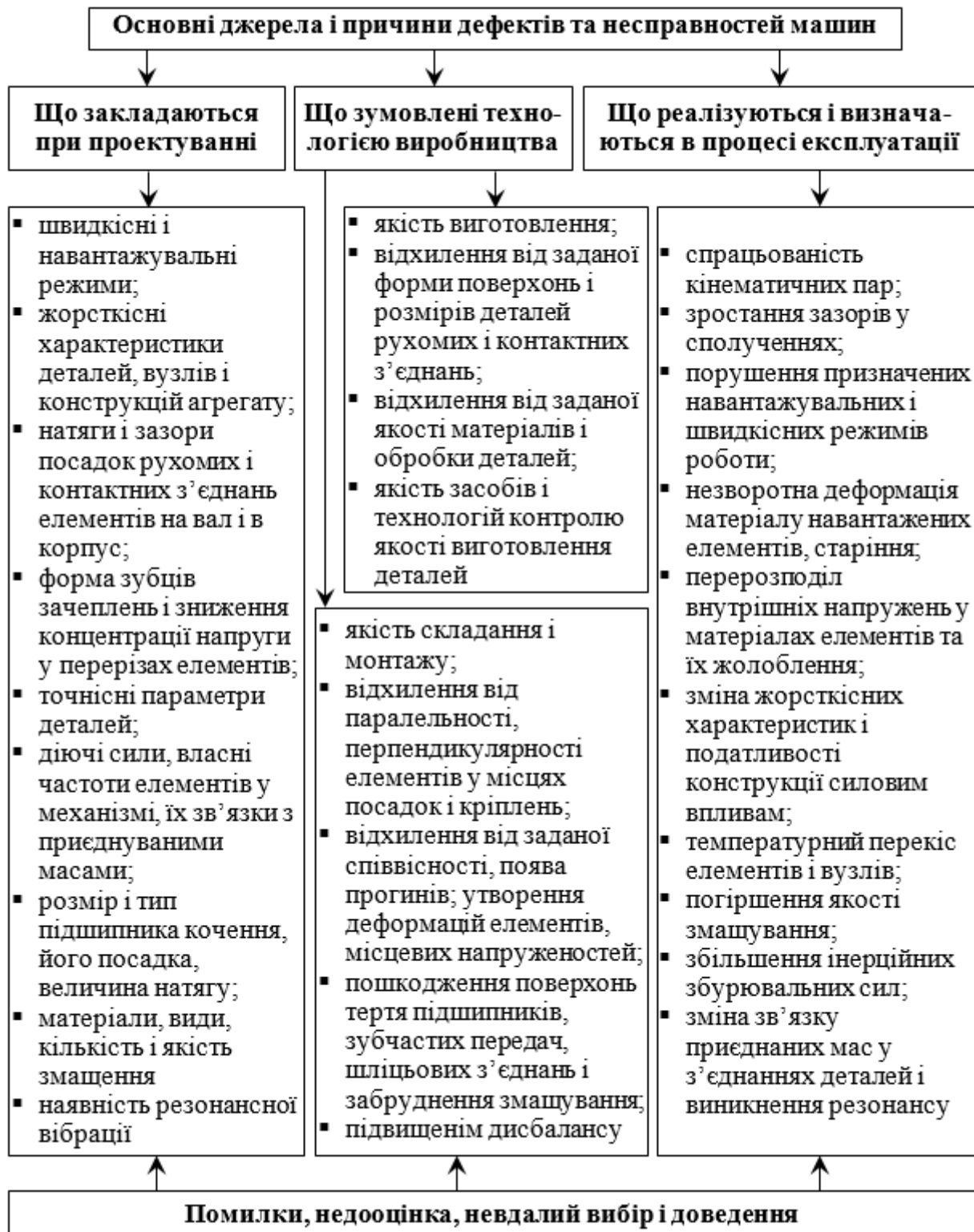
Рис. 2.1. Основні конструктивні, технологічні та експлуатаційні фактори механічного походження, які впливають на технічний стан машини
