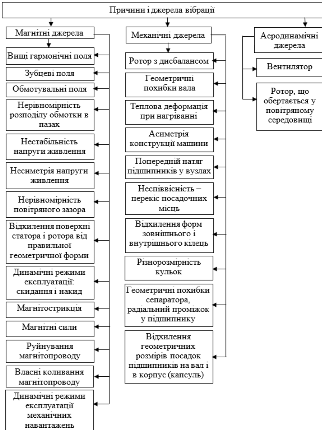
Рис. 2.26. Причини та джерела вібрації електромагнітного, механічного та аеродинамічного походження асинхронного електродвигуна
