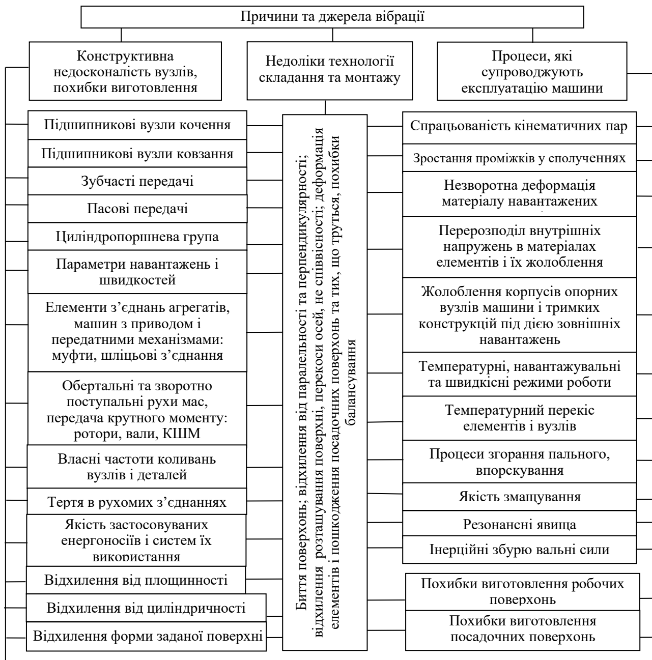
Рис. 2.13. Причини і джерела вібрації машини механічного походження
