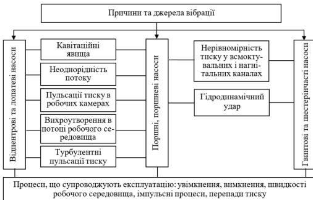
Рис. 2.31. Причини і джерела вібрації гідродинамічного походження
