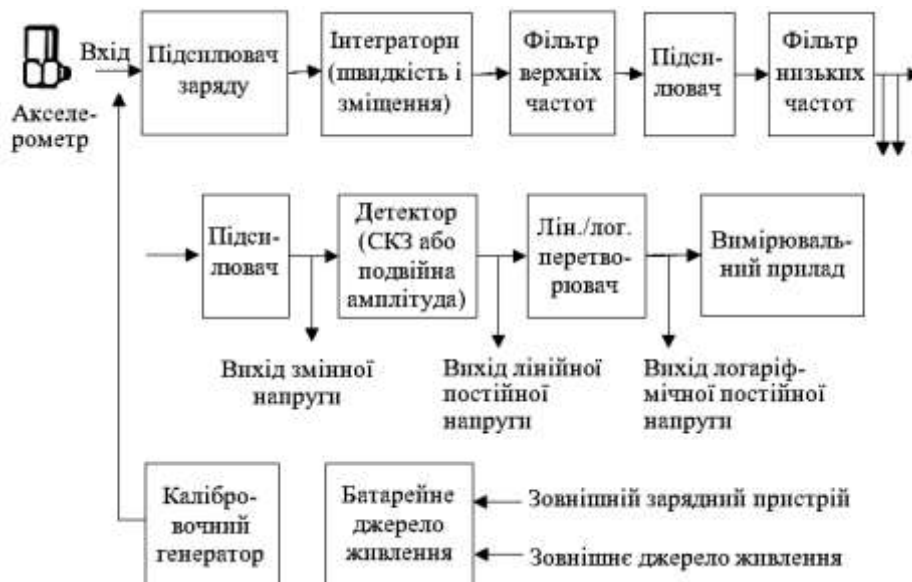
Рис. 4.16. Блок-схема конструкції й принципу дії віброметра
