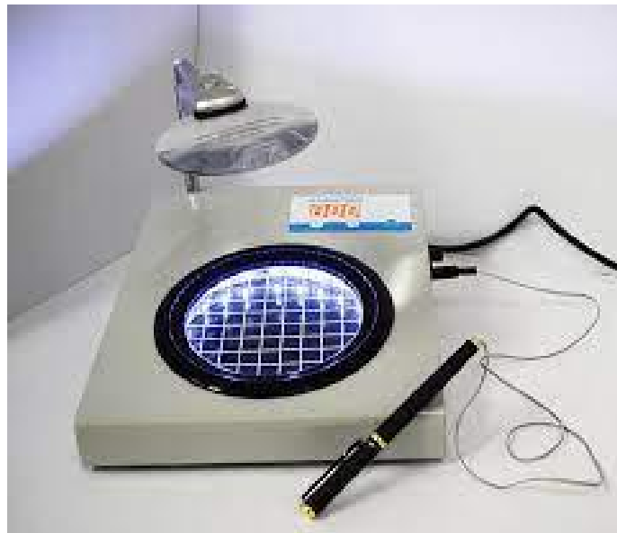
Рис. 21. Лічильник колоній мікроорганізмів СКМ-2.
