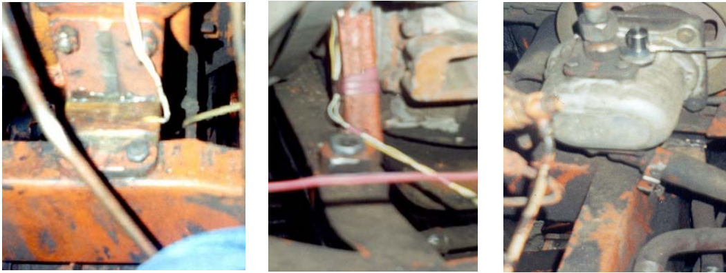
Рисунок 1 – Розміщення тензодатчиків в місцях кріплення двигуна на раму: а – задня ліва опора; б – передня ліва опора; в – насос ГСТ
