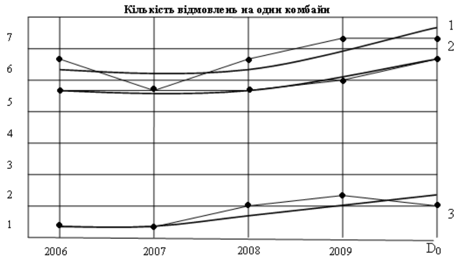
Рис. 2. Зміна відносної кількості відновлень за групами складності для комбайнів, що попередньо відпрацювали один рік («1»): 1. перша група складності (I); 2. друга група складності (II); 3. третя група складності (III)
