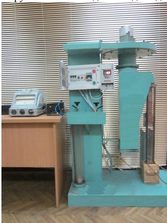
Рисунок 1 – Принципова схема удосконаленого пневмосепаратора: 1 – станина, 2 – вентилятор, 3 – башньовий сепаратор, 4 – фільтруюча секція, 5 – трубка вимірювання швидкості повітря, 6 – пристрій регулювання швидкості повітря, 7 – насіннева місткість, 8 – завантажувальний бункер, 9 – вібродозатор, 10 – сепарувальний канал, 11 – втягуючий отвір, 12, 13 – місткості для насіння, 14 – фільтр, 15 – болти, 16 – кришка фільтруючої секції, 17 – електропровідні пластини, 18 – електродвигун, 19 – блок керування; 20 – джерело високої напруги.
