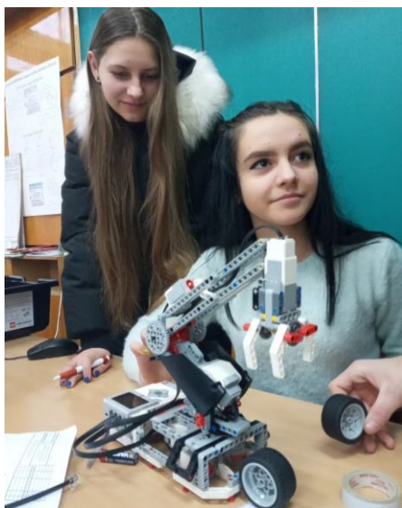
Рис. 2. Студенти на кафедрі ОПХВ збирають Lego - модель маніпулятора на базі універсального керуючого процесора
