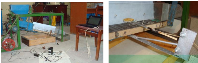
Рис. 4. Тензометрирование сдвигового усилия в слое при сепарировании ЗС кукурузы на плоском решетке
